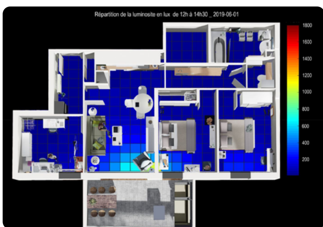
Figure 5.6. Simulation de la lumière dans l'appartement HUT (Human at home project). (Source : Stage recherche J. Jocteur et H. Ait Haddou, LIFAM 2019)
